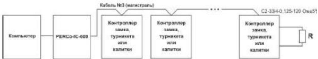
Рис. 1.2. Структурная схема соединения контроллеров замка в общую шину и подключения к компьютеру через преобразователь интерфейса
